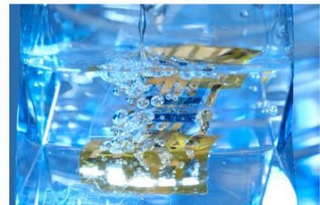
水中でも長時間駆動する超薄型有機太陽電池
